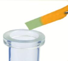
圖 51.6 用經酸化  $\text{K}_2\text{Cr}_2\text{O}_7(\text{aq})$  浸濕的濾紙測試二氧化硫
