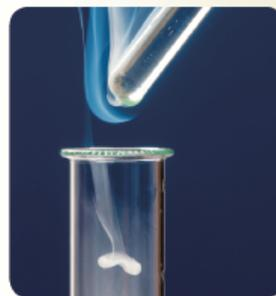
圖 51.7 用蘸上  $\text{NH}_3(\text{aq})$  的玻璃棒測試氯化氫
