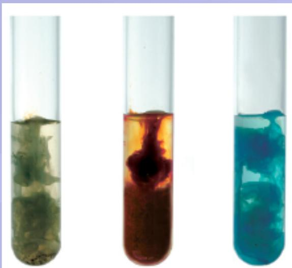
$\text{Fe}^{2+}(\text{aq})$ 、 $\text{Fe}^{3+}(\text{aq})$  和  $\text{Cu}^{2+}(\text{aq})$  離子與稀氫氧化鈉水溶液生成的沉澱物 (左至右)
